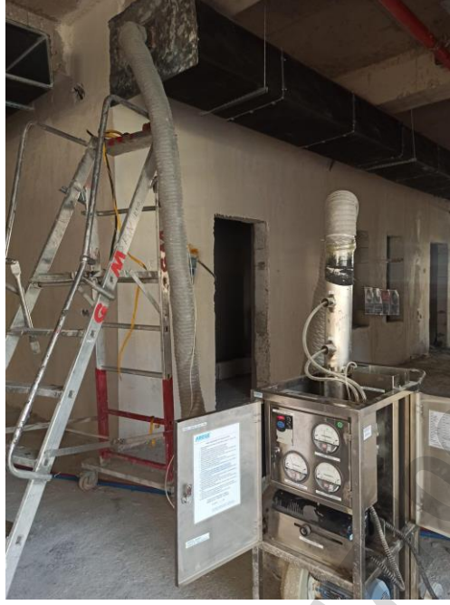
Resim 56. Havalandırma Kanalları Sızdırmazlık Testi Yapılması
