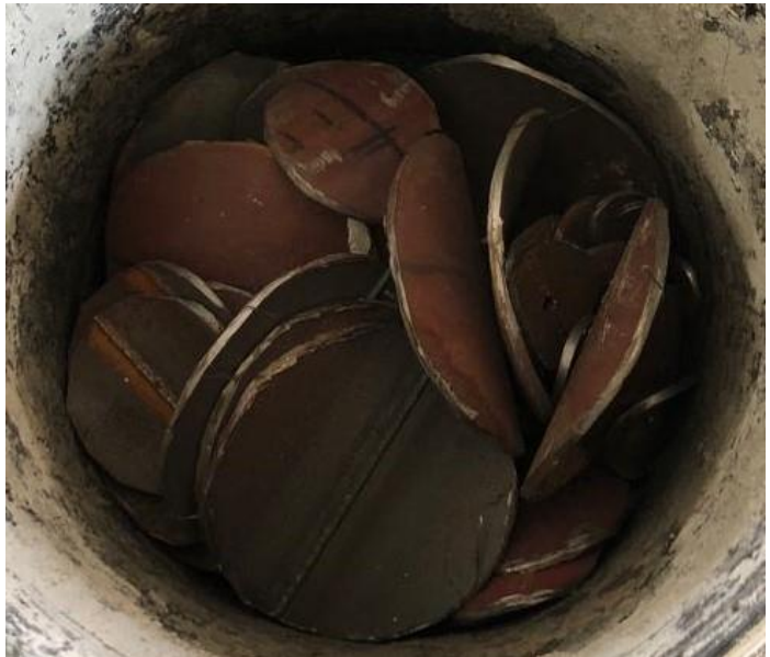
Resim 51. Açma İşlemi İle Çıkarılan Parçalara Ait Örnekler
