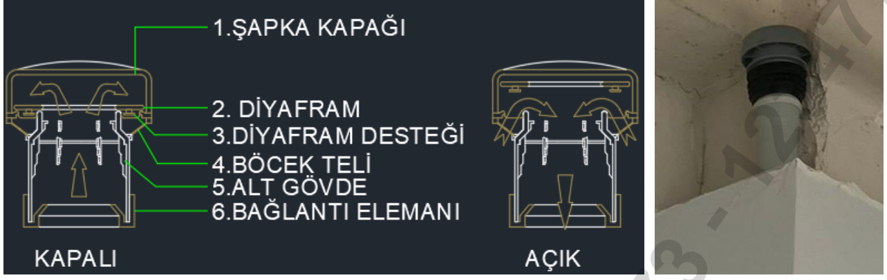
Resim 31. Otomatik Pis Su Havalık Çizim Ve İmalatı
