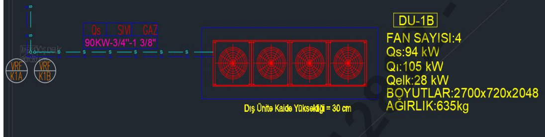
Çizim 82. Vrf Dış Ünite Çizim Örneği
